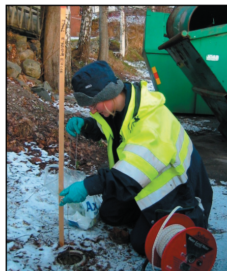
Spårämnesförsök utanför cellhallen i EKA-området
