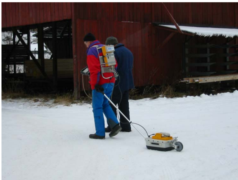
Figur 4.2 Georadarmätning Bengtsfors, december 2002.
