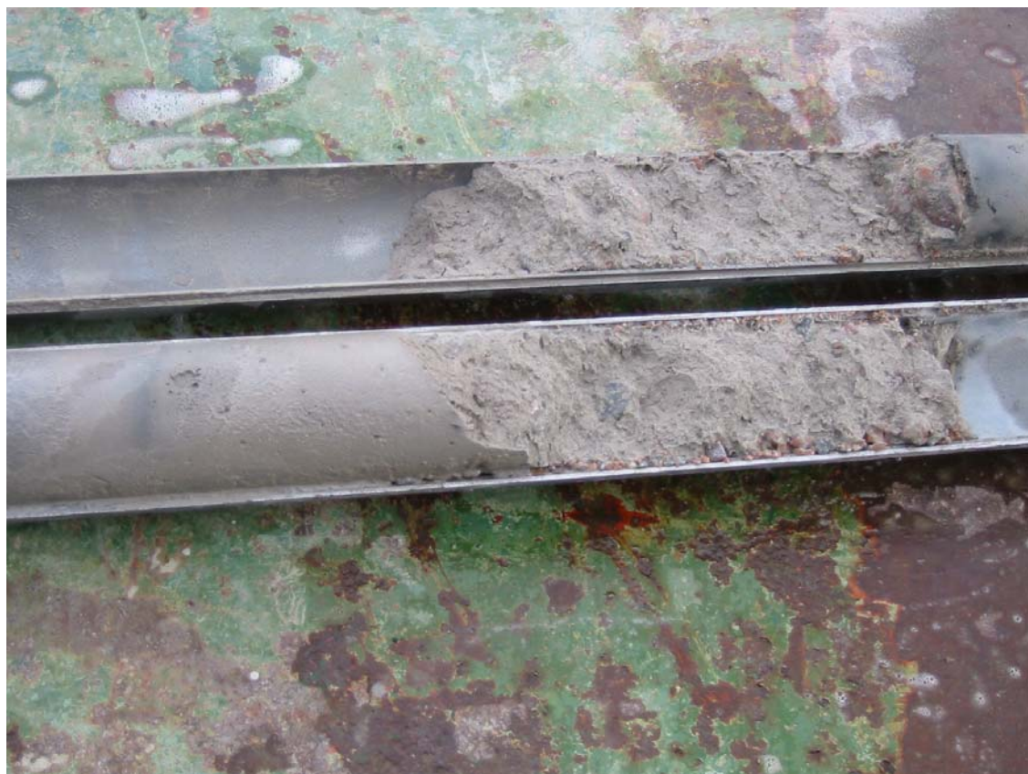
Figur 4.5 Provtagning med moränprovtagare, grusig sandig siltig morän.
