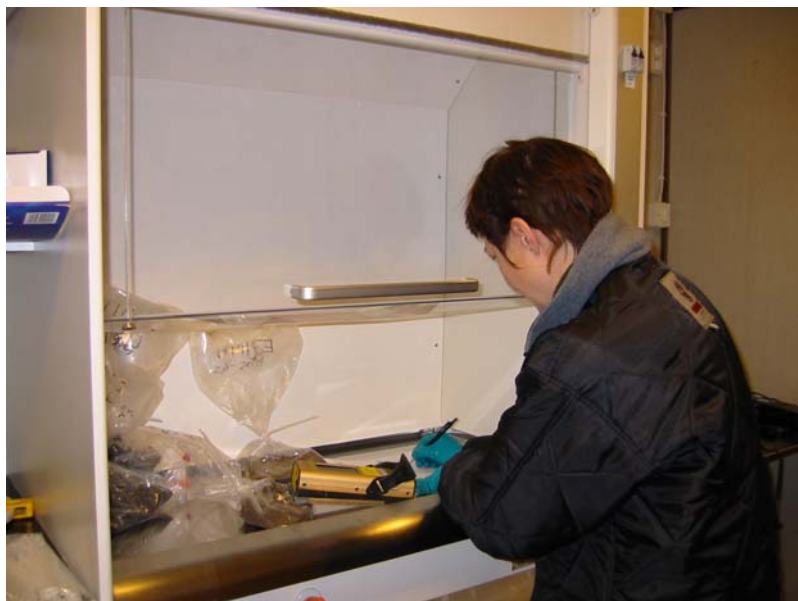
Dragskåp för bl.a. XRF-analys av jord- och konstruktionsmaterial.
