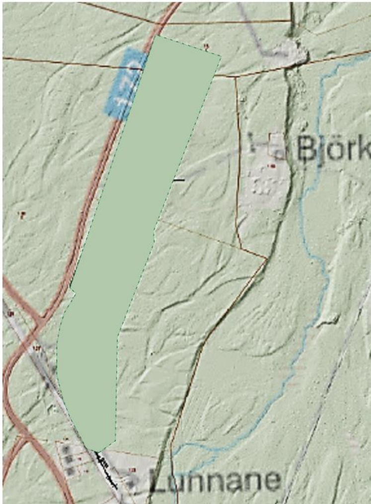
Figur 9 Utplanad yta vid anläggande av omlastningsterminal i område med strömrännor på sandurplan inom Ödskölts moar. Bakgrundsbild Sigma (2020).
