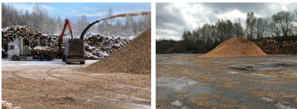
Bild på flisningskampanj, flisningsmaskin och flisstack.
