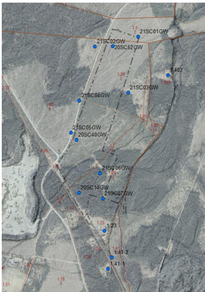
Kartbild som visar utplacerade grundvattenrör inom och i närheten av planområdet samt inmätta brunnar i anslutning till planområdet.
